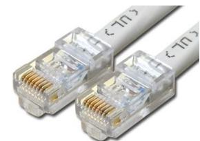
V konektoru (i zásuvce) jsou vodiče umístěny v řadě za sebou a jejich pořadí je určeno standardem TIA/EIA-568-B z roku 2001, nověji TIA/EIA-568-C z roku 2014. Standard ve skutečnosti určuje dvě pořadí – T568A a T568B (pozor, neplést si písmenka s verzí standardu), přičemž u přímého kabelu se na obou koncích použije pořadí podle T568B, kdežto u kříženého na každém konci jedno z těchto pořadí. Pozor, nejde jenom o obrácení pořadí!
