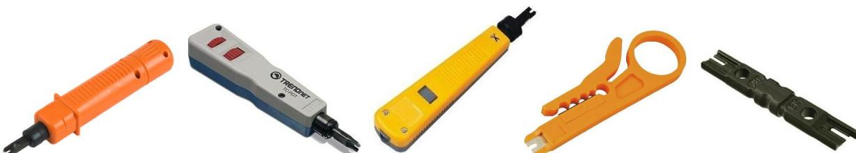
Obrázek 5.14: Zařezávací nástroje (Zdroj: aspa.cz, alza.cz, tsbohemia.cz)
