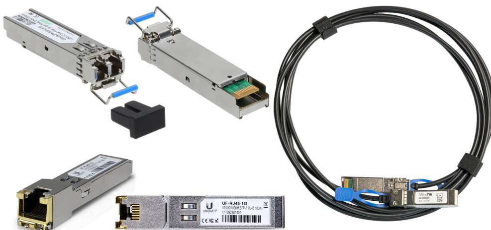
Obrázek 1.4: Různé druhy SFP modulů. Zdroj: abctech.cz
